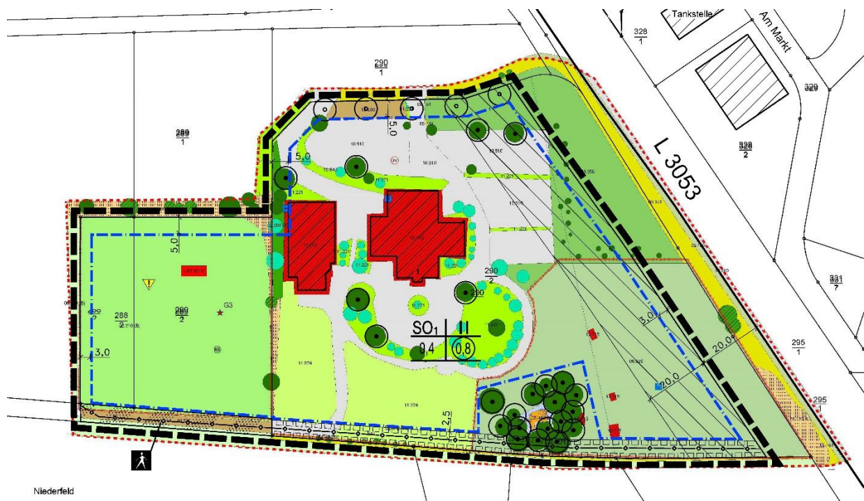
Abb. 2: Überlagerung des Bestandsplanes mit dem Bebauungsplan, Bereich des Sondergebietes mit Index 1
